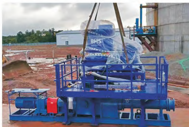
Бункерный насос MX транспортирует соломенную смесь
