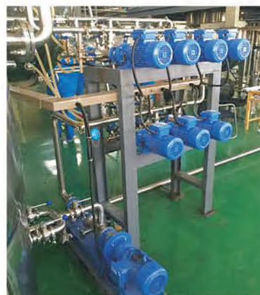
Санитарно-пищевой насос транспортирует экстракт лекарства китайской медицины
