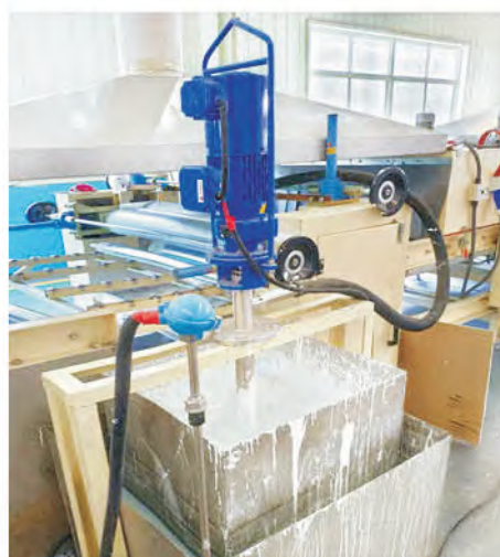
Вертикальный насос перекачивает краску
