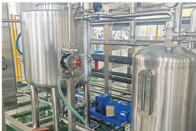
Санитарный насос транспортирует фруктовый жом
