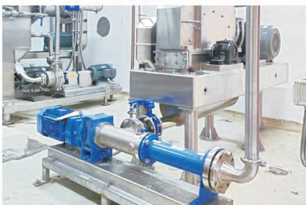
Моноблочный насос транспортирует крахмальную пульпу
