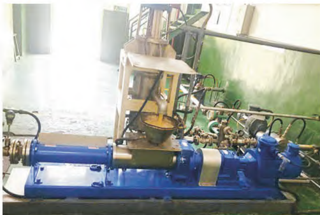
Бункерный насос MI транспортирует эмульсионный субстрат
