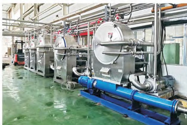
Бункерный насос M5 перекачивает картофельный жом
