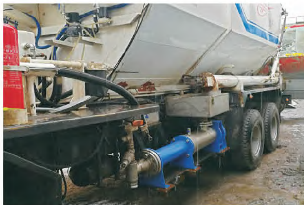
Насос с подшипниковой коробкой перекачивает субстрат
